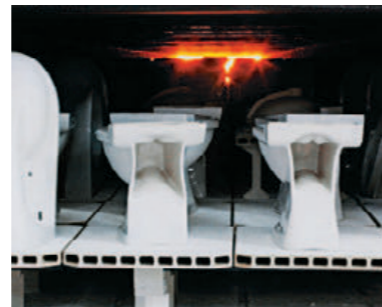
Usušené a glazované výrobky se vypalují při teplotě až 1240 °C.
