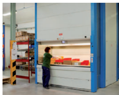
KARDEX. Velkokapacitní automatizovaný skladovací systém.
