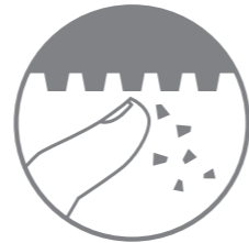
Funkce pro snadné čištění trysek sprchy. Měkké gumičky při lehkém dotyku zaručují snadné olamování vodního kamene.
