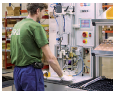
Vzduchový test na montážní lince.
