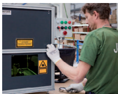
Laser při procesu vypalování loga.
