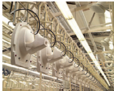
FKS – poloautomatická linka s podílem ruční práce.
